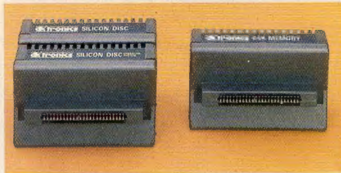
Bild 1. Die dk'tronics-Silicon-Disc besteht in der 256-KByte-Version aus zwei Modulen; dem Betriebssystem und dem Speicher, während die Arbeitsspeicher-Erweiterung in einem Gehäuse Platz findet.
